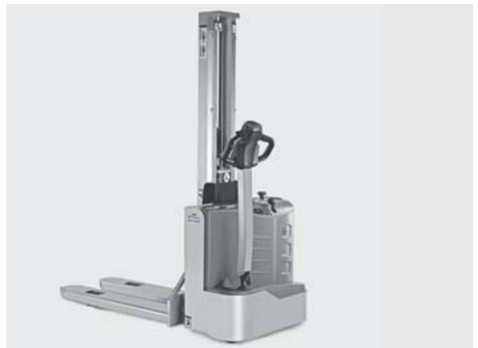
El reducido peso de servicio posibilita el uso en altillos y entreplantas o en montacargas
