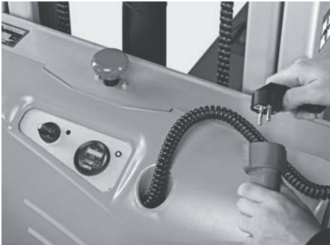
El cargador integrado garantiza una disponibilidad máxima y permite la carga descentralizada
