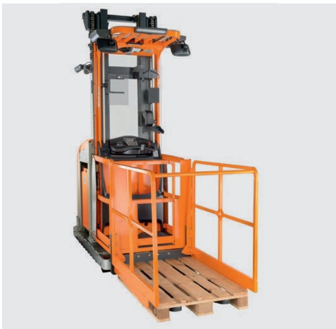
Palet accesible con protección como opción para la preparación ergonómica de pedidos de mercancías pesadas y voluminosas
